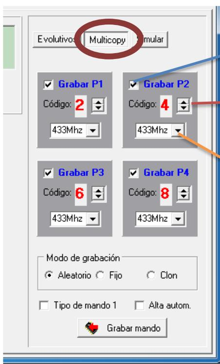
Activar o desactivar si queremos grabar el pulsador 2 del mando PC ROLL. Por ejemplo si el mando ORIGINAL tuviera un solo botón marcaríamos solo P1 y desmarcaríamos P2, P3 y P4.
